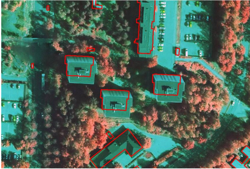
Kuva 4. Ortoilmakuvien säteissiirtymästä johtuva korkeiden rakennusten sijainnin siirtymä ilmakuvalla rakennuspolygoniin (punainen viiva) nähden.
