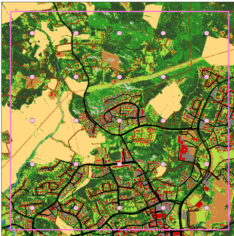
Kuva 10. Yhden testiruudun sisään generoitu 500 metrin tasavälinen referenssipisteistö.
