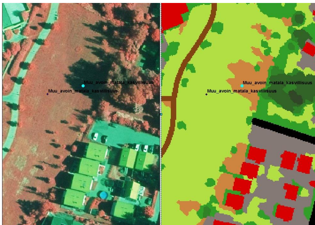
Kuva 20. Varjon vaikutus luokittelutulokseen. Referenssipisteitä auringossa ja varjossa.
