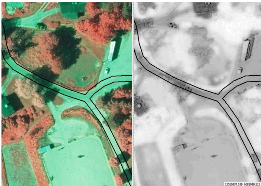
Kuva 4. Ortoilmakuva (vas) ja ortokuvasta laskettu NDVI-rasteri (oik).
