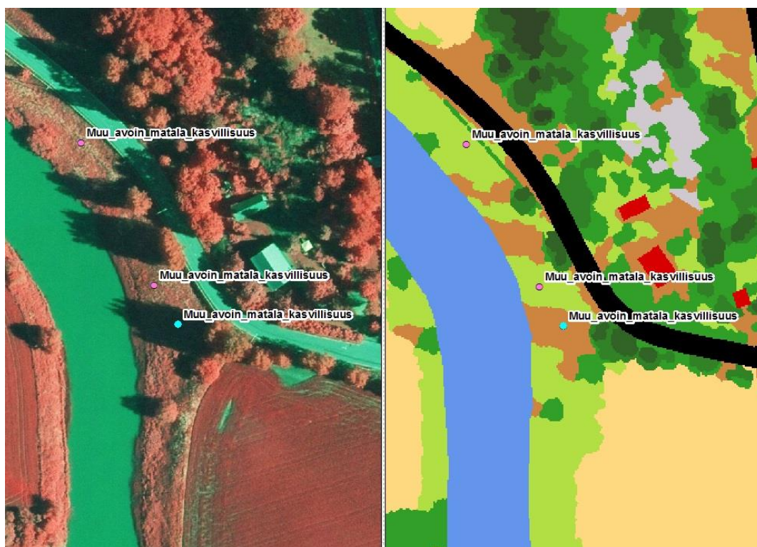
Kuva 19. Varjon vaikutus luokittelutulokseen. Referenssipisteitä auringossa ja varjossa.
