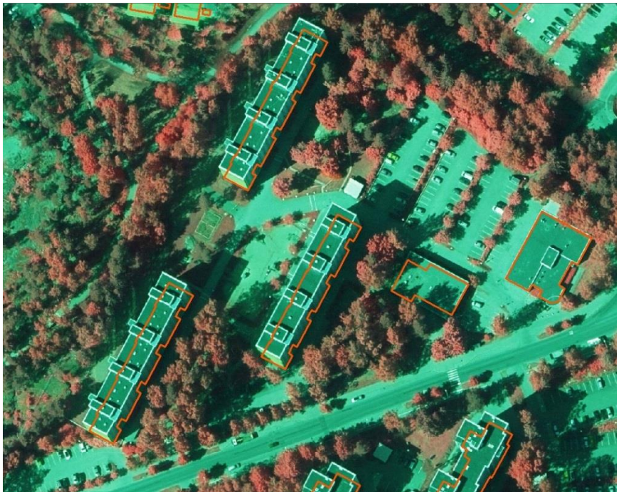
Kuva 6. Ortoilmakuvien säteissiirtymästä johtuva korkeiden rakennusten sijainnin siirtyminen ilmakuvalla rakennuspolygoniin (punainen viiva) nähden.
