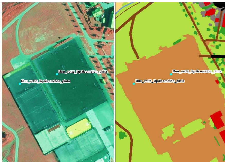
Kuva 15. Vettä läpäisemätön pinta-referenssipisteitä keinonurmella. Luokittelutulos paljas maa.
