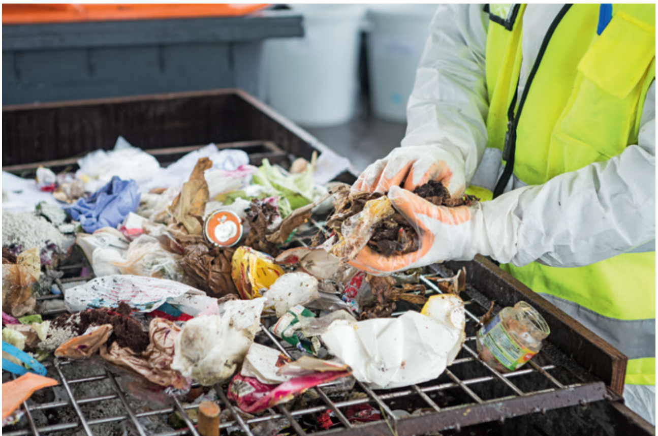
Kuva 9. Käsinsortauksessa käytetty lajittelupöytä 50 mm:n seulalla.
